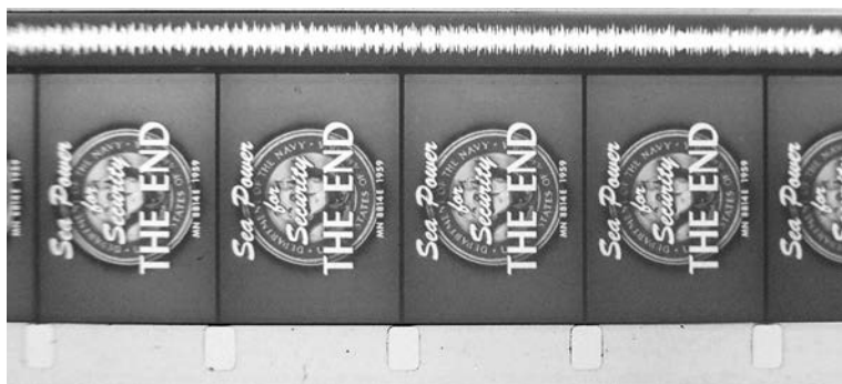
Fig. 2: Bande de son optique sur film 16mm (U.S. Navy training film, 1959).
