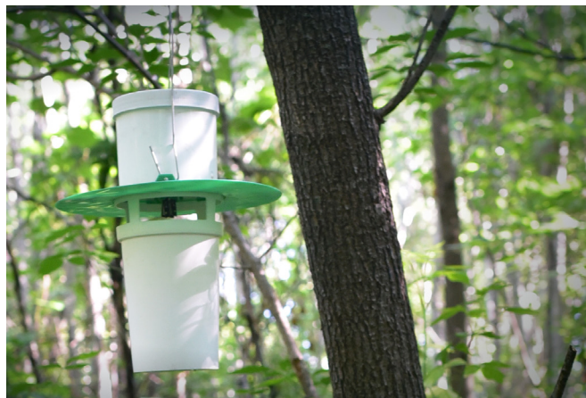
Figure 2. Piège lumineux de type Luminoc MD utilisé pour capturer les spécimens dans les stations permanentes d'inventaire.
