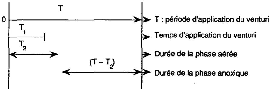
L'aération séquentielle permet, outre l'amélioration de la décantation, une amélioration de la qualité de l'eau épurée avec nitrification et dénitrification (fig. 6). La comparaison des figures 5 et 6 permet de montrer la bonne dénitrification résultant de la non aération pendant le temps  $T_3 = T - T_2$ .
