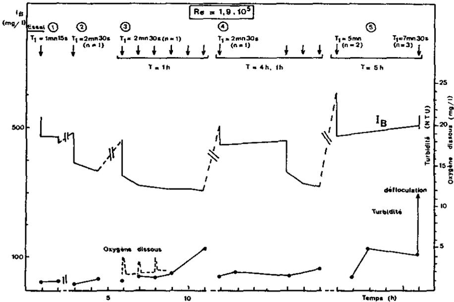
Figure 3 Evolution de l' $I_B$  en fonction de la durée ( $T_1$ ) et de la périodicité ( $T$ ), pour  $Re = 1,9 \cdot 10^5$ .
