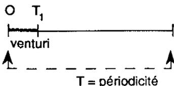
L'aération du bassin de boues activées est maintenue en permanence. La pompe et le venturi sont utilisés pendant un court moment  $T_1$  à une périodicité  $T$ .
