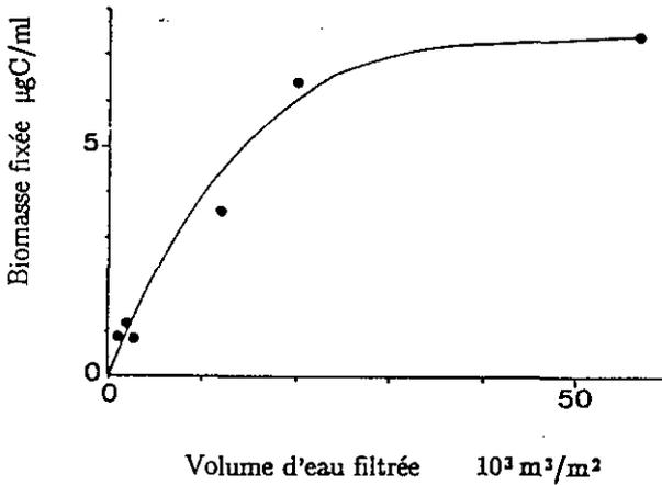
Figure 1 Biomasse moyenne fixée dans le filtre n° 56 en fonction du volume d'eau filtrée par celui-ci (exprimée en m<sup>3</sup> d'eau par m<sup>2</sup> de filtre).
