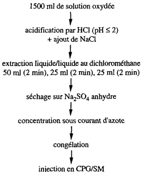
**Figure 3** Protocole d'extraction et de concentration avant analyse en CPG/SM.
