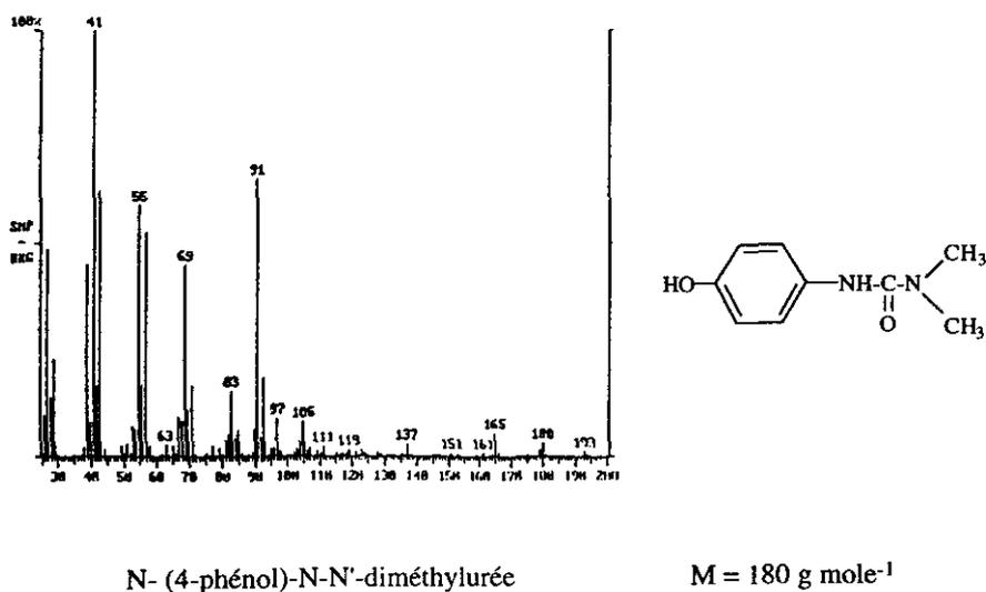
**Figure 14** Spectre de masse et structure moléculaire du composé relatif au pic 12.
