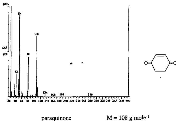
**Figure 9** Spectre de masse et structure moléculaire du composé relatif au pic 1.
