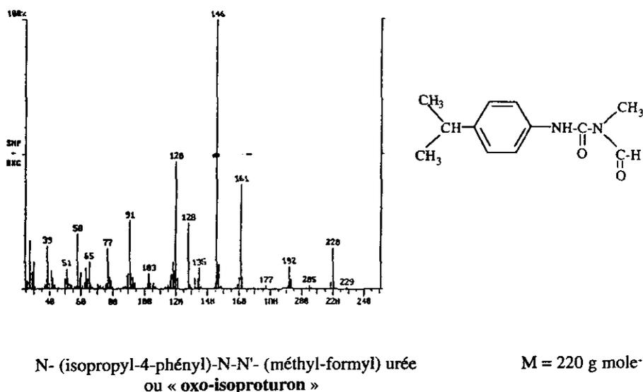
**Figure 15** Spectre de masse et structure moléculaire du composé relatif au pic 14.
