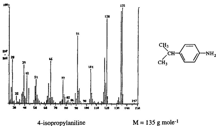
**Figure 10** Spectre de masse et structure moléculaire du composé relatif au pic 5.
