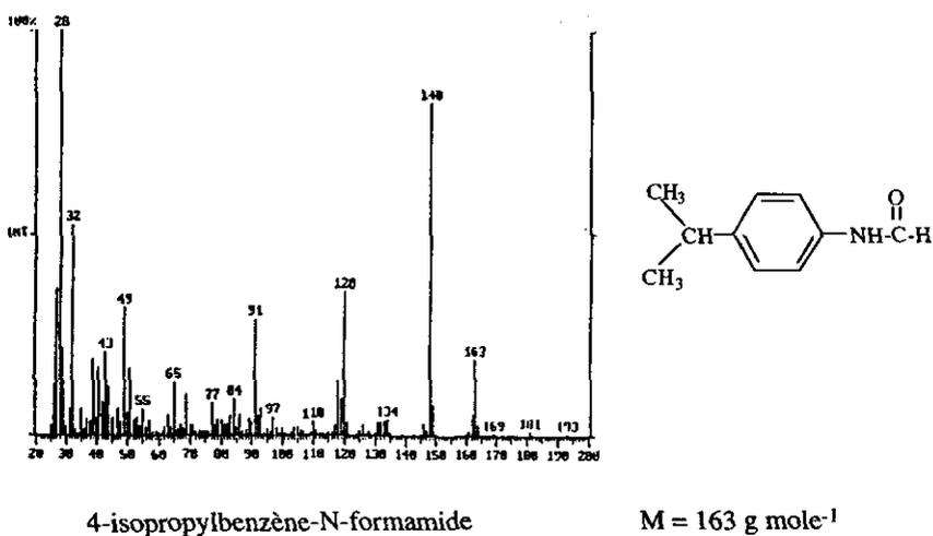
**Figure 12** Spectre de masse et structure moléculaire du composé relatif au pic 9.
