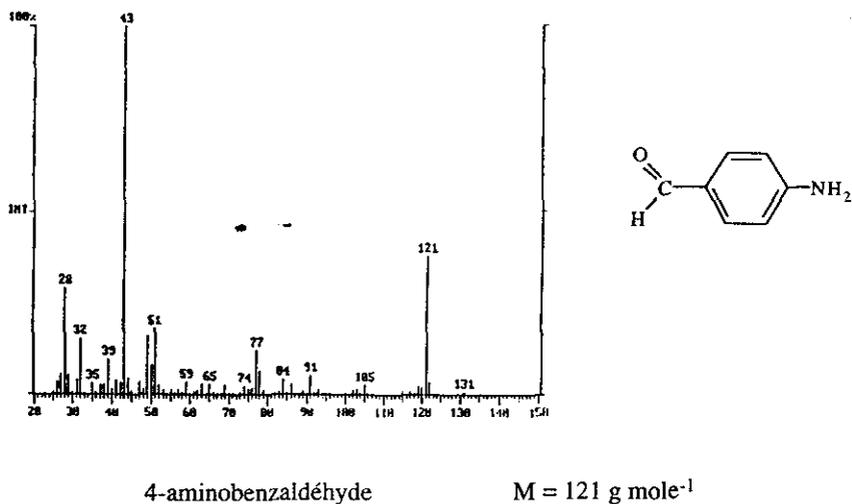
**Figure 11** Spectre de masse et structure moléculaire du composé relatif au pic 6.
