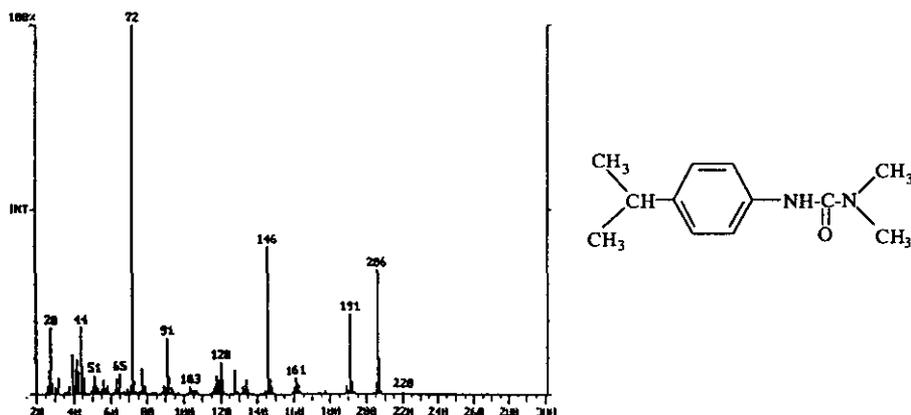
Figure 8 Spectre de masse et structure moléculaire de l'isoproturon.
