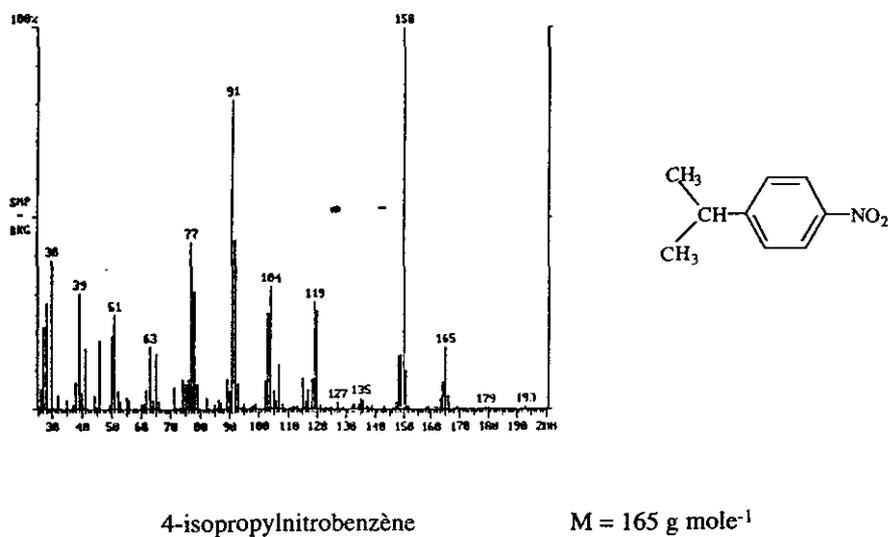
**Figure 13** Spectre de masse et structure moléculaire du composé relatif au pic 10.
