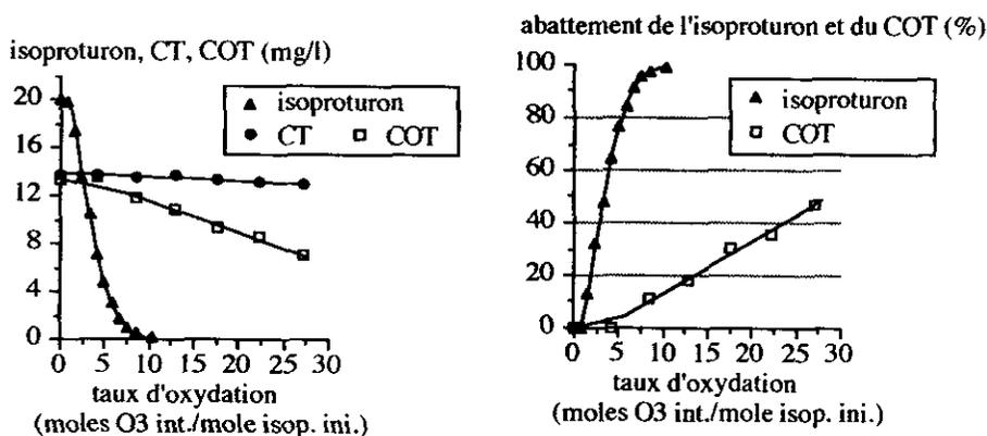
Figure 4 Evolution des concentrations, et des pourcentages d'abattement en isoproturon et carbone, au cours de l'oxydation par  $\text{O}_3/\text{H}_2\text{O}_2$ . (a) Evolution of isoproturon, total organic carbon and total carbon concentrations as a function of the quantity of ozone introduced. (b) Removal of isoproturon and total organic carbon under the same conditions.
