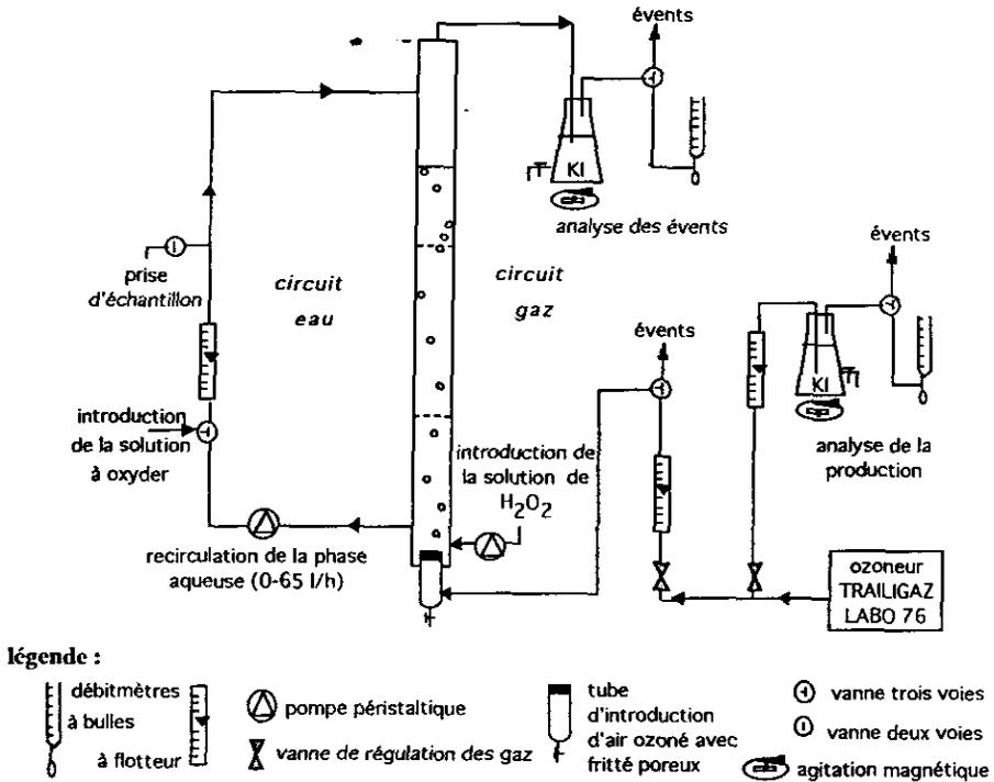
Figure 2 Montage d'oxydation.
