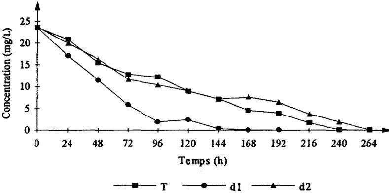
**Figure 7** Élimination du phénol par *L. minor* avec  $C_0 = 24$  mg/L.
