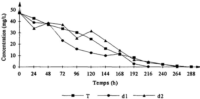
**Figure 8** Élimination du phénol par *L. minor* avec  $C_0 = 48$  mg/L.
