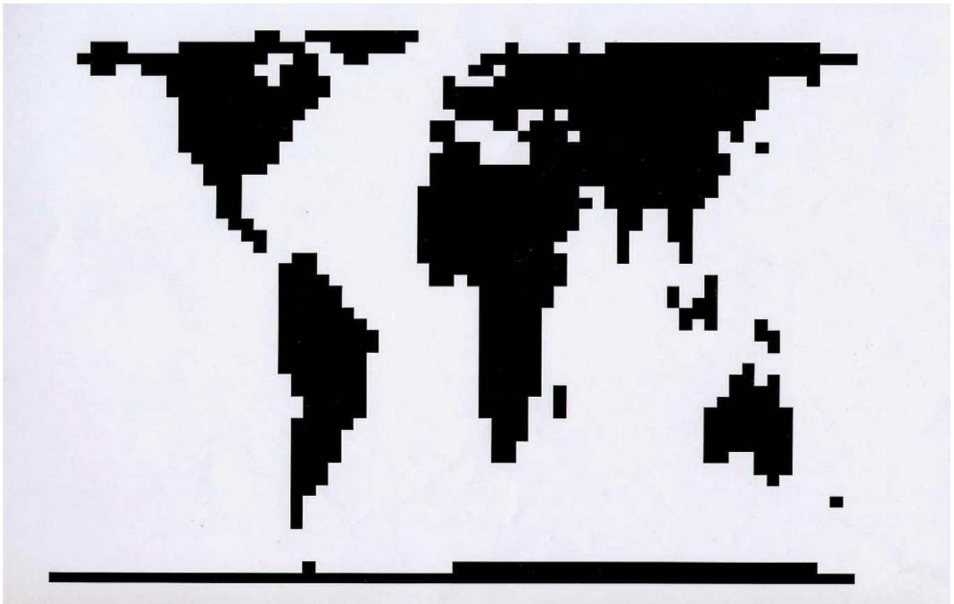
Figure 2. Allure des masses continentales à travers le prisme du maillage spatial d'un Modèle de circulation générale. Continent masses as seen through the grid of a General Circulation Model.
