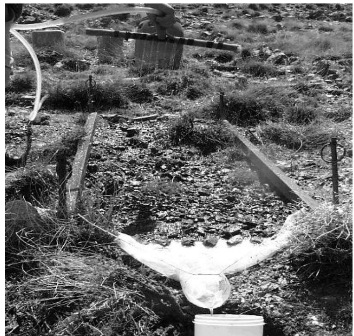
Figure1. Dispositif du test d'infiltrométrie. On distingue en haut de la placette le bidon d'eau, au dessus de la placette la rampe d'arrosage, et en bas le collecteur de ruissellement. System used for the infiltrimeter tests. The water tank can be seen above the top the plot, the irrigation ramp is above the plot, and the runoff collector at the bottom.
