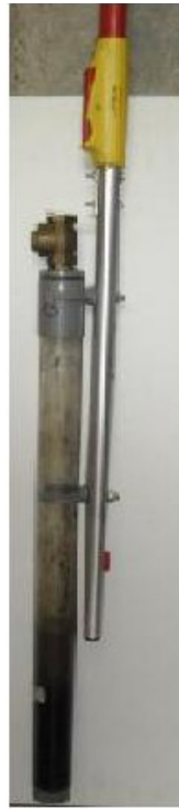
Figure 3. Système de carottage des sédiments. Sludge coring apparatus.
