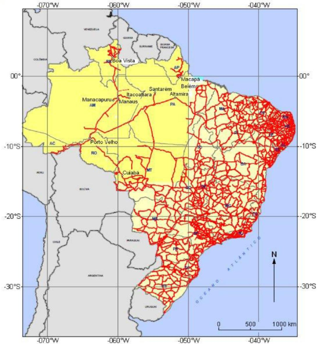
**Figure 1. Les mailles de nivellement de précision au Brésil (document IBGE).**
