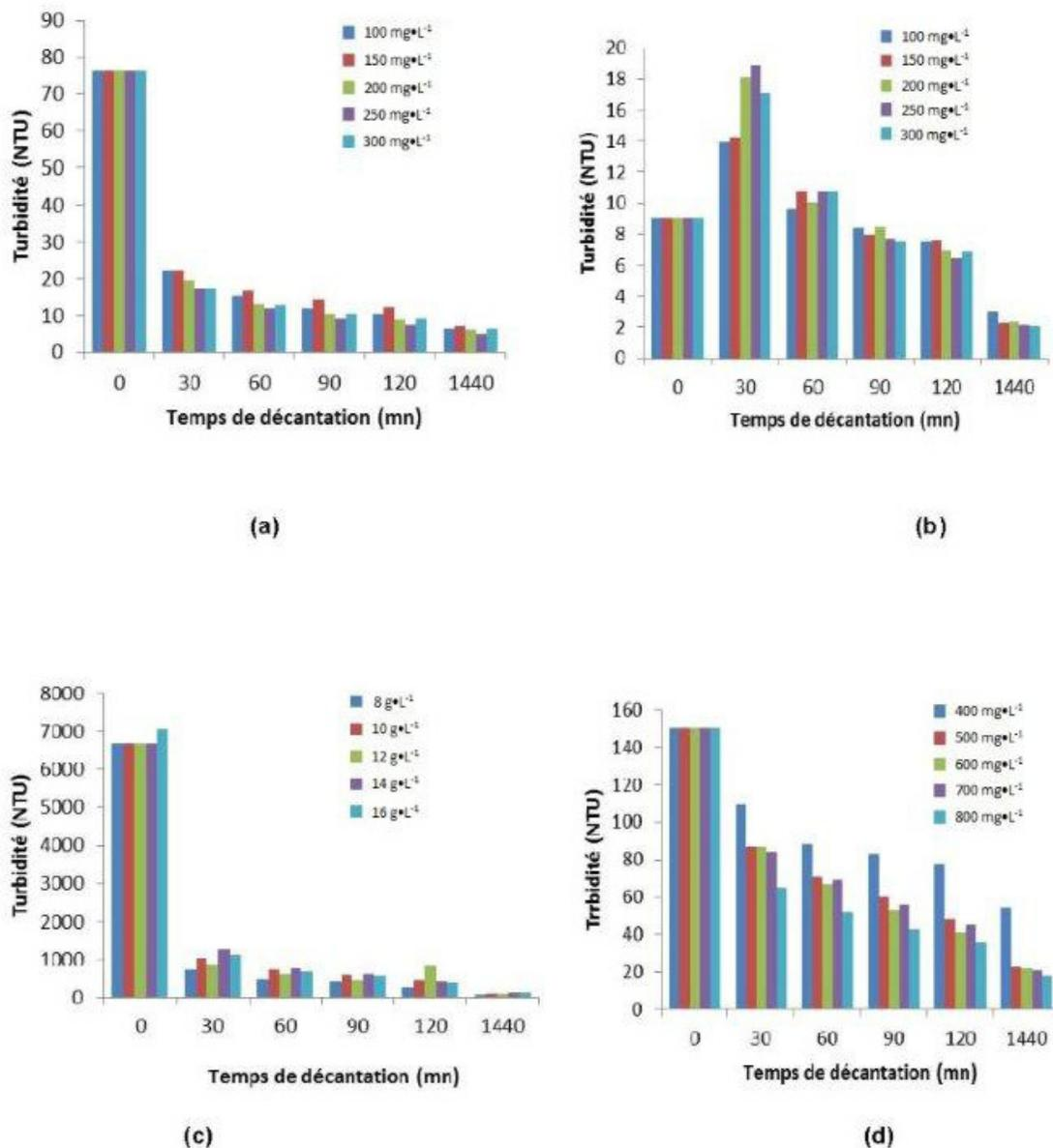
Figure 1. Évolution de la turbidité des eaux en fonction du temps de décantation pour différentes concentrations de *Moringa oleifera*: (a) Loumbila, (b) Ouaga3, (c) Gana, (d) Bouaré.
